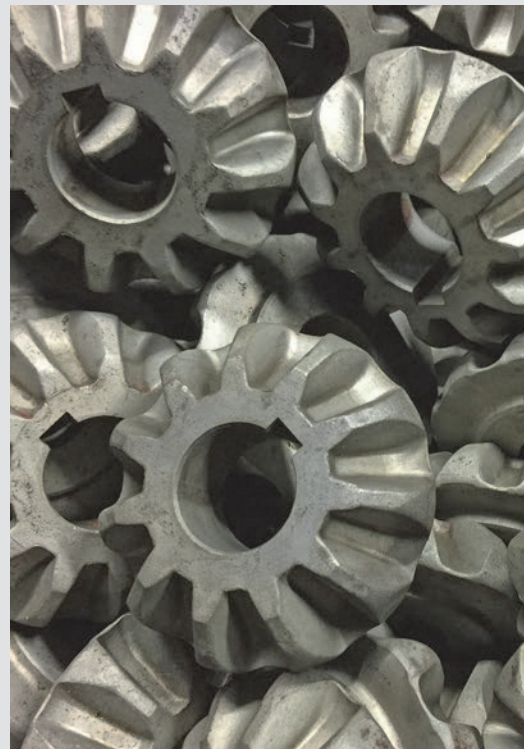
Engranajes moldeados e impresos en alta resistencia
