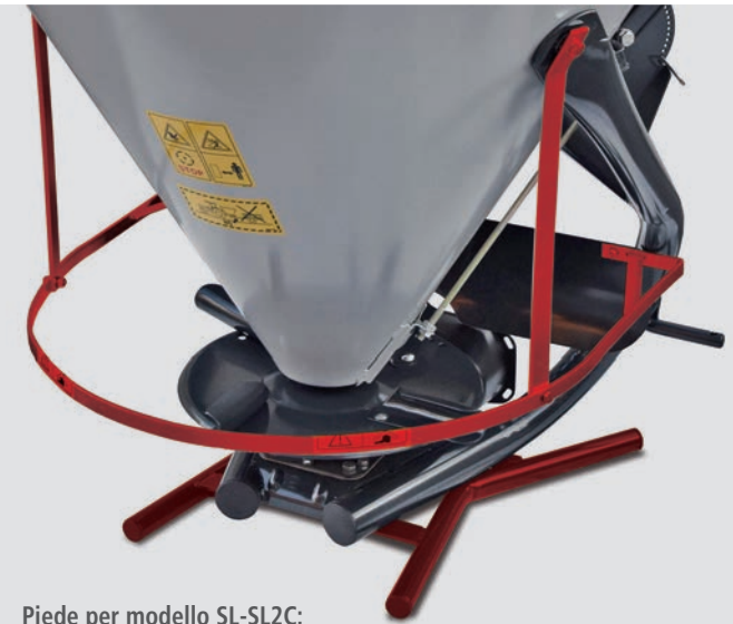
Piede per modello SL-SL2C: impedisce l'eventuale ribaltamento della macchina quando posizionata sul terreno.
