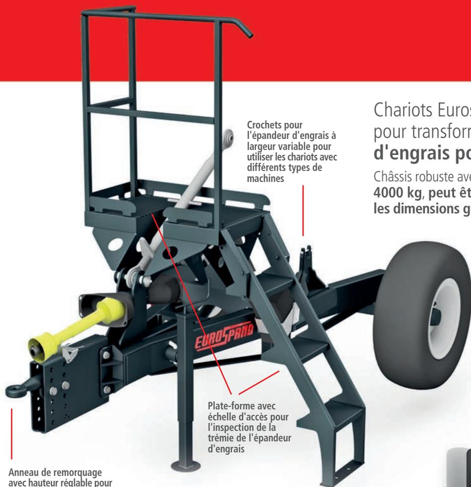
Crochets pour l'épandeur d'engrais à largeur variable pour utiliser les chariots avec différents types de machines
